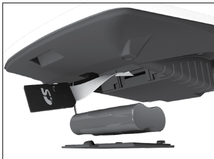
Obrázok 2.8 – Zavedenie SD karty do pokladnice
