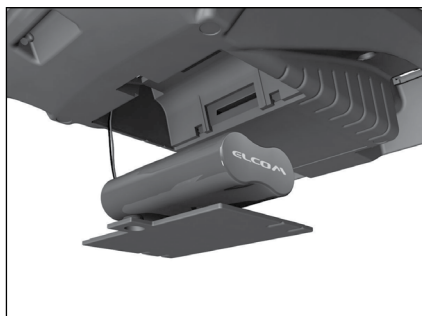
Obrázok 2.8 – Zavedenie SD karty do pokladnice
